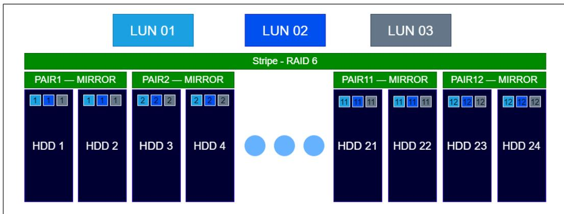
В примере 1 показана организация RAID10 на группе из 24 дисков. На группе дисков созданы блочные устройства с уровнем защиты - RAID-10. Все блочные устройства размещаются на одном и том же количестве дисков в группе.
