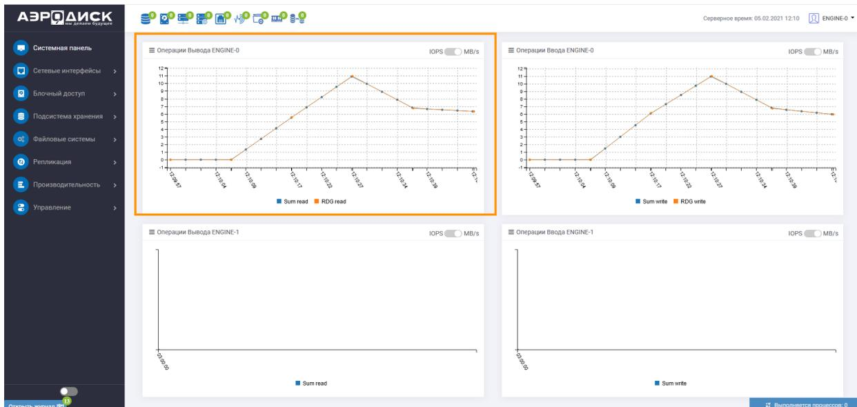
Страница показывает суммарную нагрузку на блочные устройства (LUN-ы) по операциям ввода-вывода (IOPS), нагрузке в мегабайтах в секунду (MB/s). Для переключения отображаемой информации по нагрузке нужно нажать ползунок «IOPS – MB/s»
