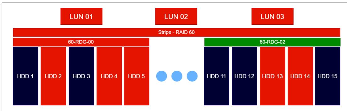
В примере 3 отражен выход из строя трех физических дисков в VDEV 60-RDG-00, с типом 60-RDG.
