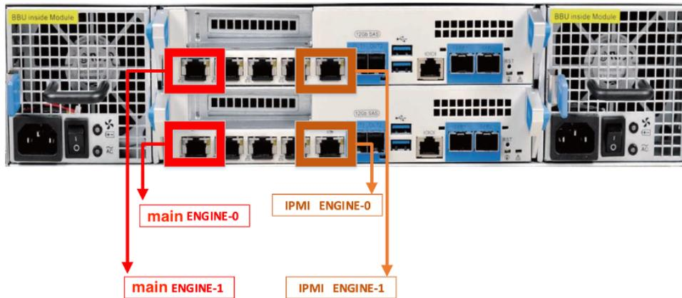
MAIN - Ethernet порты используются для подключения к веб интерфейсу системы; IPMI - Ethernet порты используются для подключения к интерфейсу IPMI системы.
