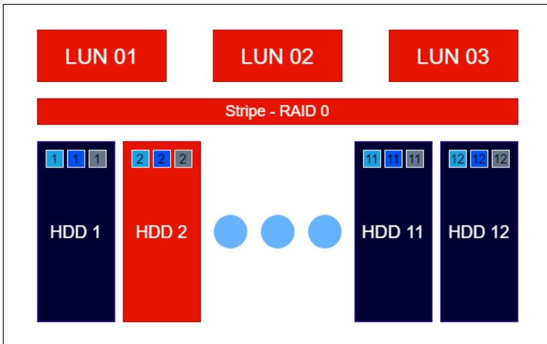
В примере 2 отражен выход из строя 1-го физического диска в группе дисков для блочных устройств с защитой RAID-0. Такая ситуация считается фатальной, данные недоступны для чтения-записи. Следует заменить диски и восстановить данные из резервных копий.
