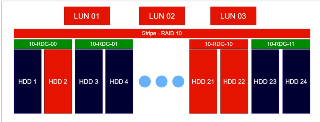
В примере 3 отражен выход из строя 2-х физических дисков в одной VDEV с типом 10-RDG. Такая ситуация считается фатальной, все данные в RDG недоступны для чтения/записи, следует заменить диски и восстановить данные из резервных копий.
