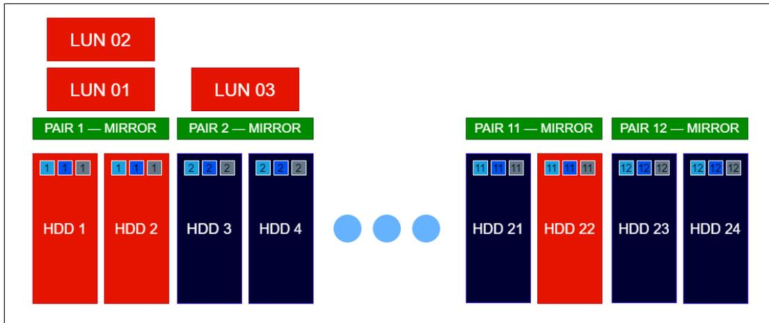
В примере 3 отражен выход из строя 2-х физических дисков в одной паре. Такая ситуация считается фатальной для блочных устройств, находящихся на этой паре, данные недоступны для чтения/записи. Следует заменить диски и восстановить данные из резервных копий.
