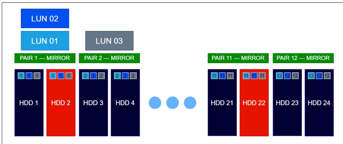
В примере 2 отражен выход из строя нескольких физических дисков в разных парах дисков. Такая ситуация считается критичной, данные доступны для чтения/записи, но отказоустойчивость отсутствует, выход из строя ещё одного диска в паре грозит потерей всех данных. Следует незамедлительно заменить сбойные диски.
