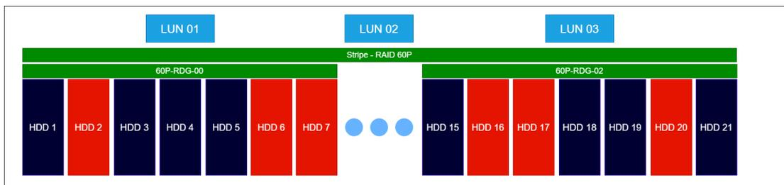
В примере 2 отражен выход из строя 3-х физических дисков в разных VDEV с типом 60P-RDG. Такая ситуация считается критичной, но не фатальной, данные по-прежнему доступны для чтения и записи, но отказоустойчивость отсутствует, выход из строя ещё одного из дисков в затронутых VDEV грозит потерей всех данных. Следует незамедлительно заменить сбойные диски.
