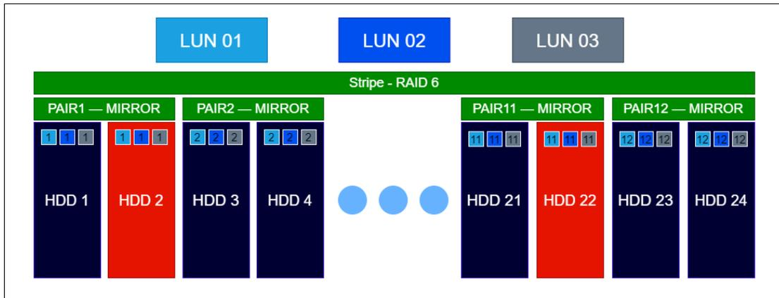
В примере 2 отражен выход из строя нескольких физических дисков в разных парах дисков. Такая ситуация считается критичной, данные доступны для чтения/записи, но отказоустойчивость отсутствует, выход из строя ещё одного диска в паре грозит потерей всех данных. Следует незамедлительно заменить сбойные диски.
