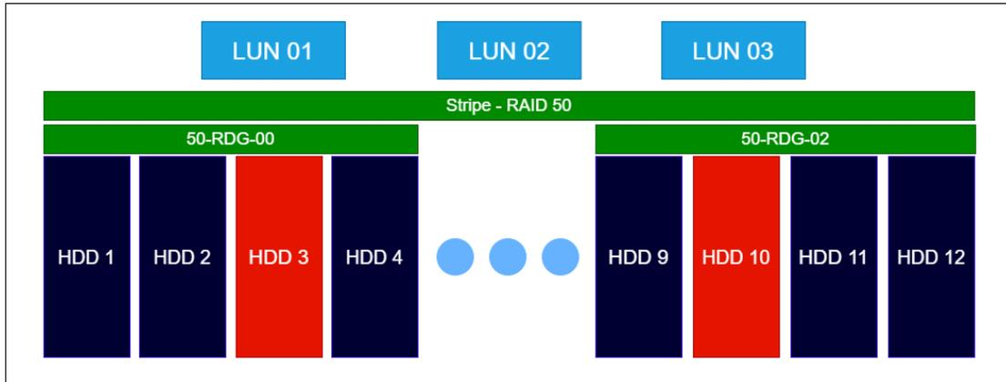
В примере 2 отражен выход из строя нескольких физических дисков в разных виртуальных VDEV с типом 50-RDG. Такая ситуация считается критичной, данные по-прежнему доступны для чтения-записи, но отказоустойчивость отсутствует, выход из строя ещё одного из дисков грозит потерей всех данных. Следует незамедлительно заменить сбойные диски.
