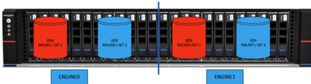
Как видно из примера, RDG и DDP-группы равномерно распределены по двум системным контроллерам СХД. Системные ресурсы СХД используются сбалансировано, точки отказа отсутствуют.
