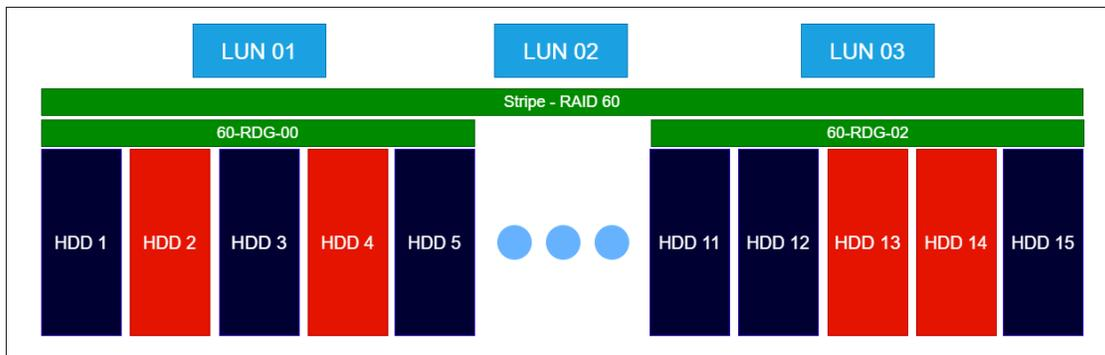
В примере 2 показан выход из строя нескольких физических дисков – по два в разных VDEV, с типом 60-RDG. Такая ситуация считается критичной, но не фатальной, данные по-прежнему доступны для чтения и записи, но отказоустойчивость отсутствует. Выход из строя ещё одного из дисков в затронутых VDEV грозит потерей всех данных. Следует незамедлительно заменить сбойные диски.
