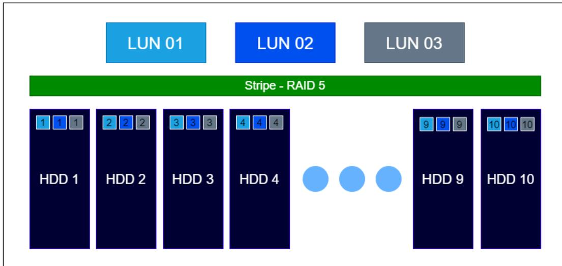
В примере 1 показана организация RAID-5 на группе из 10 дисков. Группа состоит из 10 дисков: 9 дисков под данные и 1 диск под четность. Коэффициент полезной емкости – 90%. На группе дисков созданы блочные устройства с уровнем защиты – RAID-5. Все блочные устройства размещаются на одном и том же количестве дисков в группе.
