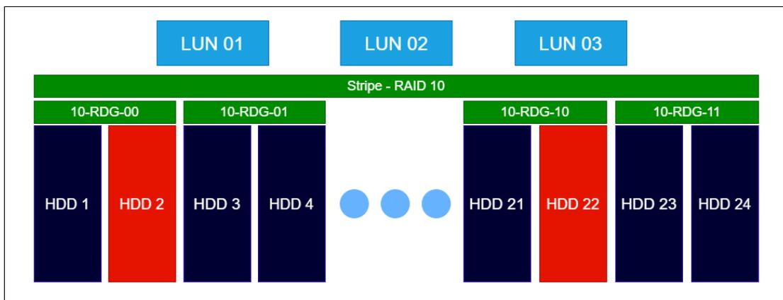
В примере 2 отражен выход из строя нескольких физических дисков в разных VDEV с типом 10-RDG. Такая ситуация считается критичной, данные доступны для чтения/записи, но отказоустойчивость отсутствует, выход из строя ещё одного из дисков в том же VDEV грозит потерей всех данных. Следует незамедлительно заменить сбойные диски.
