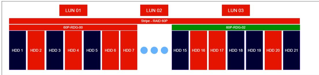
В примере 3 отражен выход из строя 4-х физических дисков в VDEV 60P-RDG-00 с типом 60P-RDG. Такая ситуация считается фатальной, так как вышло из строя одновременно четыре жестких диска (при возможных трех) в одном VDEV, данные недоступны для чтения и записи. Следует заменить диски и восстановить данные из резервных копий.
