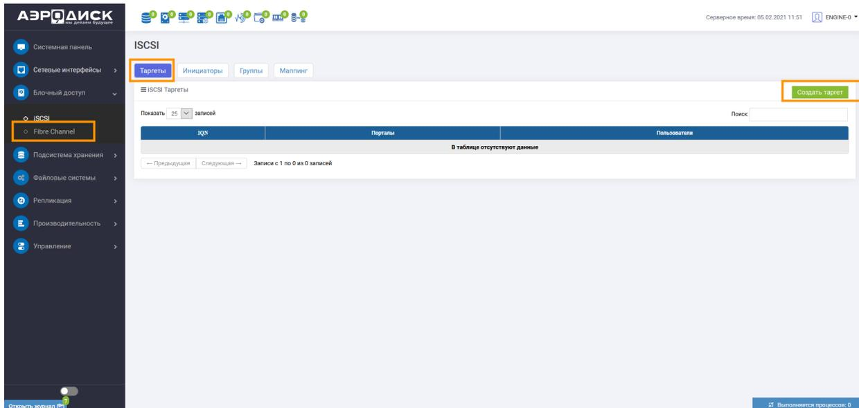
Для предоставления доступа хостов к LUN по протоколу iSCSI на СХД необходимо создать программный iSCSI-target и связать его с виртуальным IP дисковой группы RDG/DDP. Связка виртуального IP дисковой группы RDG/DDP с программным iSCSI-target по сути является аналогом зонирования в SAN-сетях.
