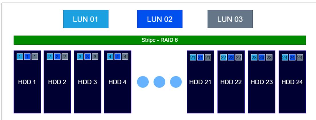
В примере 1 показана организация RAID-6 на группе из 24 дисков. Группа состоит из 24 дисков: 22 диска под данные и 2 диска под четность. Коэффициент полезной емкости – 91,6%. На группе дисков созданы блочные устройства с уровнем защиты – RAID-6. Все блочные устройства размещаются на одном и том же количестве дисков в группе.
